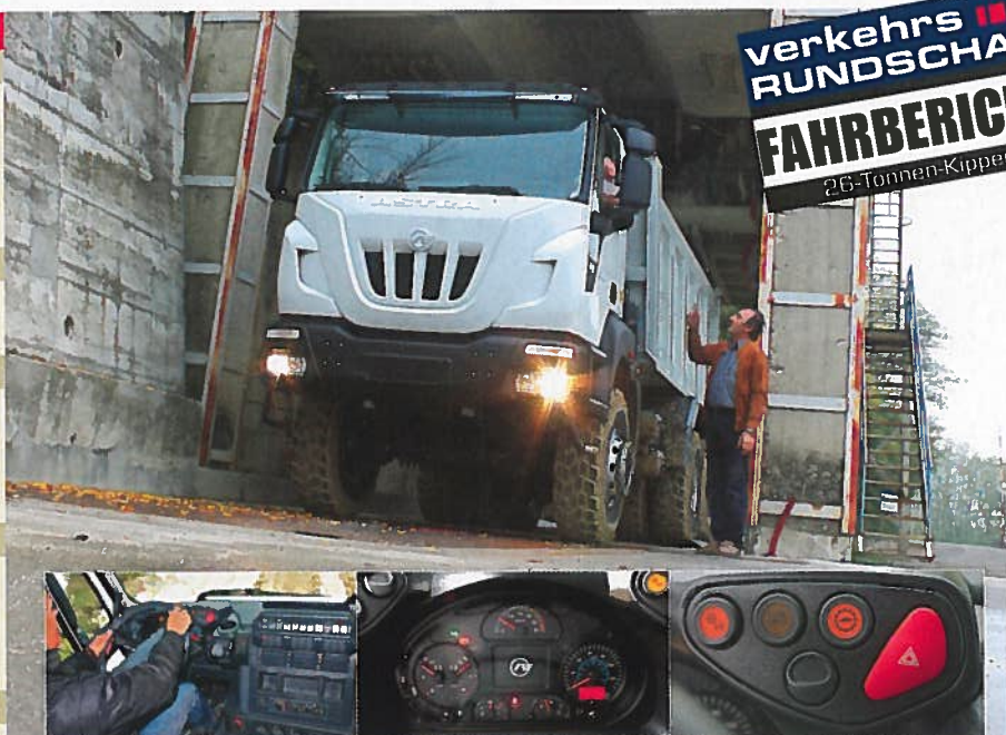
41 Tonnen auf drei Achsen: Astra auf der Waage (oben), bekanntes Iveco-Interieur mit leichtgängiger Lenkung, geänderte Instrumente mit großen Vorratsdruckanzeigen, extra Taster
