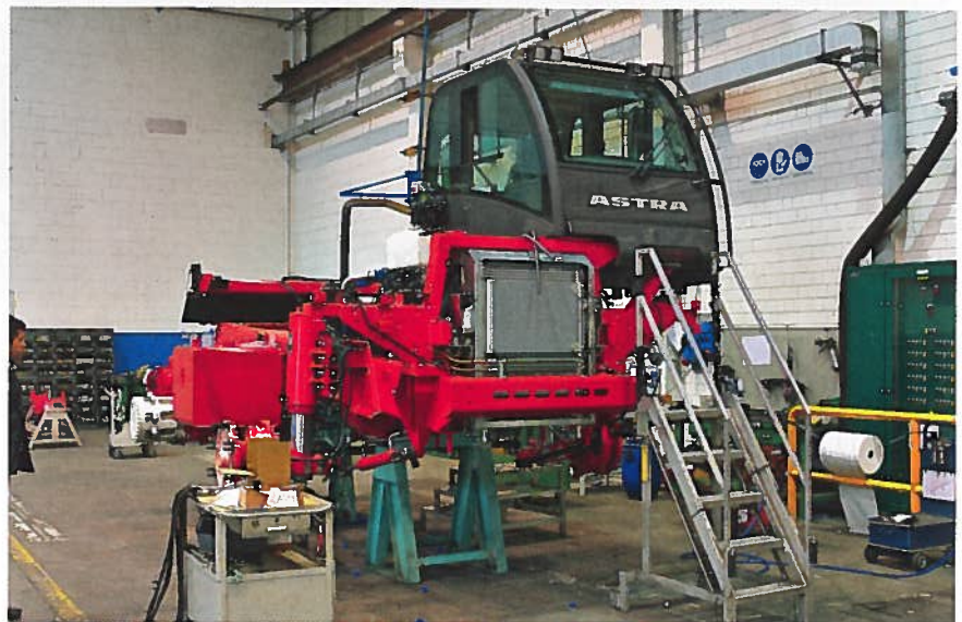
An Einzelarbeitsplätzen entstehen die schweren Dumper der RD-Serie
