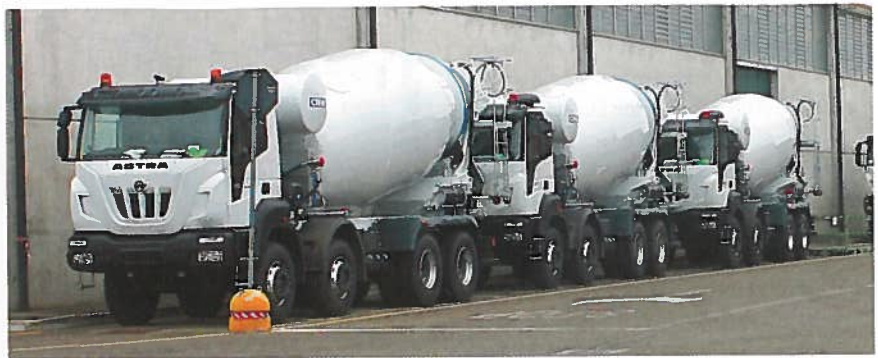
Der extrem steife Rahmen erlaubt in Italien größere Trommeln und hohe Liefergeschwindigkeiten
