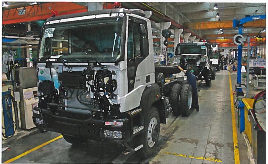
Fast wie bei Iveco: Die Endmontage der HD- und HHD-Serie erfolgt am Band
